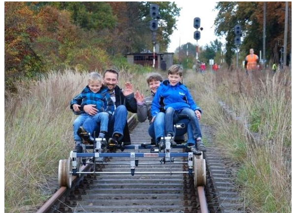
Leichtmetalldraisine mit Gangschaltung
